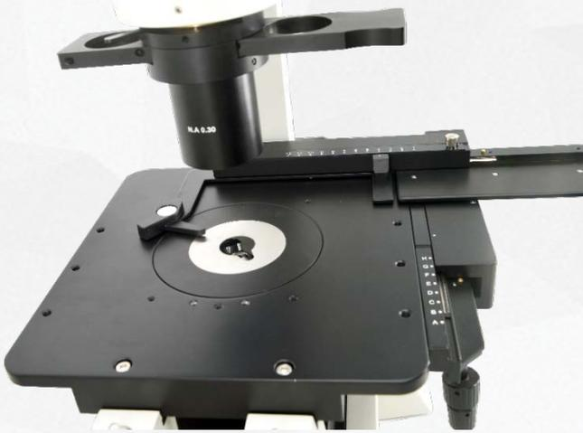
平台预留多点安装孔，可在平台上固定其它辅助仪器或扩展飘台，为膜片钳系统等提供优良的光学显微平台。
