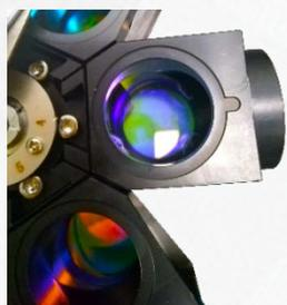
转盘式荧光激发盒可双向切换滤光片组，方便快捷，多达 7 个通道，可根据实验需要灵活加装或更换与荧光染料对应使用的滤光片组。
