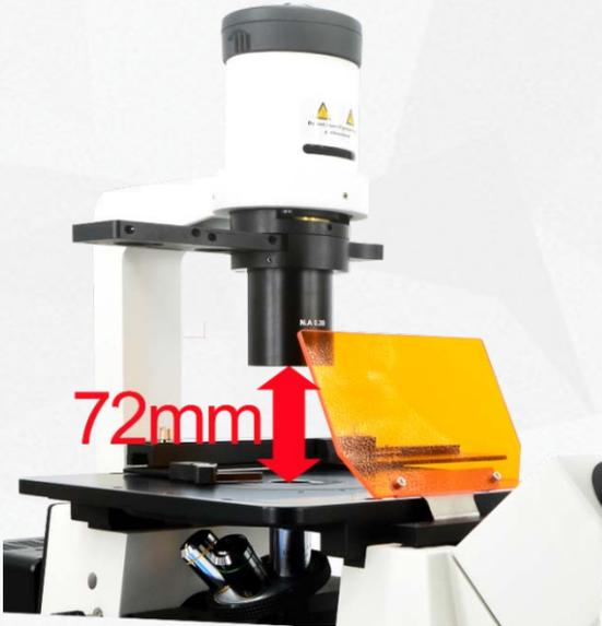
聚光镜工作距离长达 72mm,并可拆卸,当拆聚光镜后纵向空间可达 160mm,足够长的操作空间为大型细胞培养皿提供可能,如胞工厂等。
