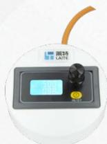
荧光激发光源系统采用新型高功率 LED 作为光源，具有使用安全方便、亮度高、随开随关、维护成本低、体积小等诸多优势于一体。宽波长激发，满足常规染料如 DAPI、CFP、Aqua、FITC、GFP、TRITC、Cy5 等实验需要。
