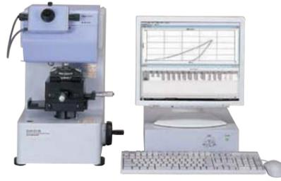
电子式万能材料试验机
