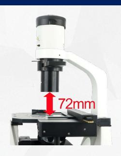
聚光镜工作距离长达 72mm, 并可拆卸, 当拆聚光镜后纵向空间可达 160mm, 足够 长的作空间为大型细胞培养皿提供可能, 如细胞工厂观察等。
