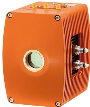
英国Raptor Photonics公司的Ninox 640 SU相机是一款科学级的深度制冷InGaAs相机，专为低照度科研短波红外成像和显微成像设计。相机分辨率640x512，像元尺寸15umx15um，满分辨率下帧频98fps，制冷温度-80℃，最大限度降低暗电流，增加曝光时间，提高图像的信噪比，以满足苛刻的弱光探测需求。
