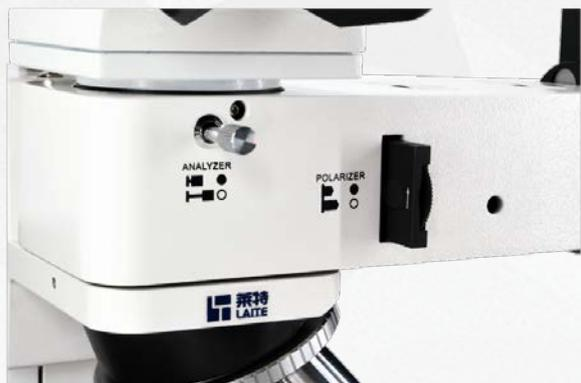
显微观察常用的操作部位，如明暗场，起偏器，孔径光样，滤色片等均前置，使用者操作起来更加方便。
