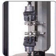
AGS-X-10kND + 气动平面夹具 + TRViewX 非接触式视频引伸计
