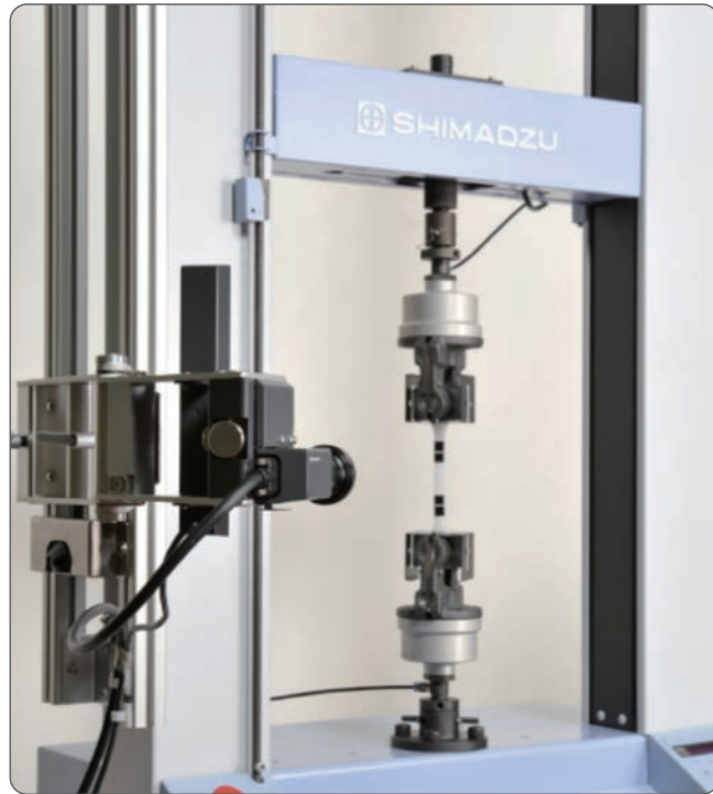
AGS-X-10kND + 气动平面夹具 + TRViewX 非接触式视频引伸计
