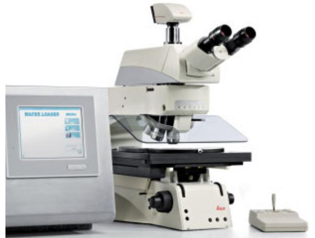
通过添加晶片装入设备和定制的检验软件，升级为检验系统
