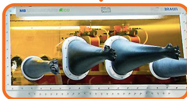
在狭缝涂布技术应用中应特别注意环境中粉尘对涂布工艺的影响。在不合格的无尘环境下进行狭缝涂布工艺，纳米级薄膜（干膜厚度）将被完全破坏。为了避免这个问题，MBRAUN开发了小型洁净系统，可以在惰性气体环境下运行，并在该环境内同时实现ISO1的洁净等级。
