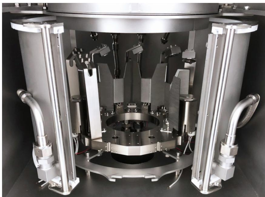
内腔室可以实现快速冷却降温，以实现出色的工艺控制，保证蒸发速率和薄膜质量的可重复性
