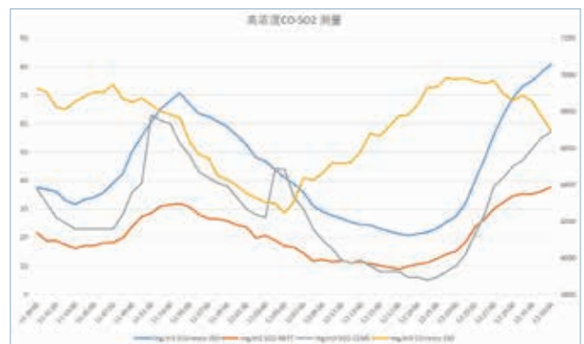
在此钢铁行业的工况中，CO 浓度在 6000-8000 ppm 左右，CEMS 用的是 NDIR 的方法测试 SO 2 ，testo 350 用的是电化学的方法，从抗干扰性来看，在低 SO 2 浓度以及高 CO 的浓度情况下可以很好的测得低浓度 SO 2 。
