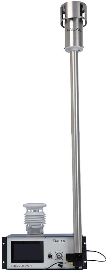
Palas®的单颗粒气溶胶粒径分布光谱仪Fidas® 200系列采用了依据米氏单颗粒光学散射理论技术,已获得多项专利保护。它的基础是获得专利的T孔径技术,生成T形三维测量体积,可以有效识别边界区域误差和重合错误。
