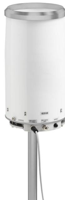
PMsense 是一款 PM1.0、PM2.5 和 PM10 颗粒物变送器，具有 RS485 Modbus-RTU 输出，适用于室外空气质量监测，使用激光散射原理测量粉尘颗粒浓度，颗粒物传感器免维护设计，响应速度快，灵敏度高，稳定性好。连续工作模式：传感器始终处于活动状态，并连续进行测量。在这种模式下，保证至少 10,000 小时的 PM 传感器寿命。不连续工作模式（默认）：当必须进行测量时，传感器会定期激活。此模式可延长 PM 传感器的使用寿命。根据要求，可选配 CO2 传感器可以集成在 PLC 或物联网中。
