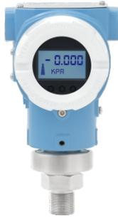
LFT700能准确测量液体、气体或蒸汽的液位、密度压力并把它转换成4~20mA DC的输出信号。该变送器可通过三按键本地操作，或通用手操器、组态软件以及手机APP远程操作，在不影响4~20mA DC的输出信的同时，进行显示与组态调整。
