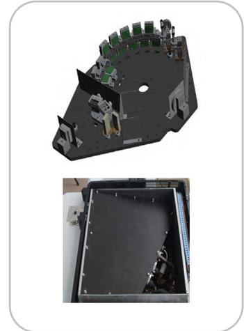
三、CX-9800光谱仪采用了特殊的真空光室系统设计，与传统的充氩式光室系统相比，其优势是巨大的。首先，在仪器非工作状态下不需要实时的对光室进行氩气吹扫，大大降低了氩气的使用量，节约了客户的使用成本。其次，创想仪器的真空光学系统保证了仪器在冷启动（关机重启）状态下30分钟即可达到稳定工作状态，而传统的充氩式光室系统需要1-2小时才能达到稳定的工作状态。
