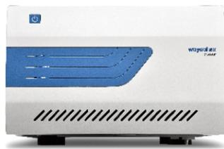
超高效二元高压泵,是超高效液相的核心部件。它采用超高压直线电机泵,最高压力150MPa,流量范围0-2mL/min,涵盖亚二微米色谱柱的最佳使用范围。
