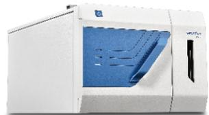
超高效自动进样器,采用超高压针在流路无损进样技术,具有极低的进样循环周期。由于进样针在高压流路中始终冲洗,具有极低的交叉污染。制冷的样品室,能够保存生物样品等易变质的被测物质。
