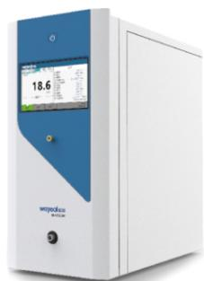
低温蒸发设计,满足热不稳定物质检测需求;
