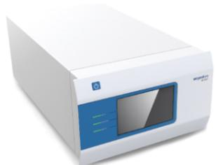
该荧光检测器以直流氙灯为光源,具备双单色器结构,可灵活设定激发波长和发射波长,满足您对不同样品的检测需求。
