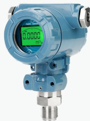
LFT6200系列压力变送器是一款隔离防爆型产品，性价比高。广泛用于气体、液体压力检测，如水、油、轻度腐蚀性液体和气体。该产品采用316L不锈钢引压头，压力芯体选用国际著名品牌，专用V/I转换电器，能方便的对其零点 and 满程进行校准。本产品具有漂移量小，性能稳定、质量可靠，结构合理等优点。
