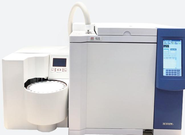
本系统依据国家标准GB 50325-2020《民用建筑工程室内环境污染控制标准》附录D及附录E中要求，采用全自动二次热解吸仪HD-F24联用全自动气相色谱仪GC128，适用于民用建筑工程室内环境中TVOC、苯、甲苯和二甲苯的测定。
