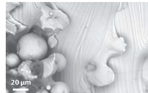
附加使用选择性激光熔化加工的钛合金 (Ti-6Al-4V) 表面，在未熔化的 Ti-6Al-4V 颗粒和其他材料旁边呈现出完全熔化的区域。在蔡司 EVO 15 下使用 BSE 探测器成像。样品由 TWI Ltd. 提供。
