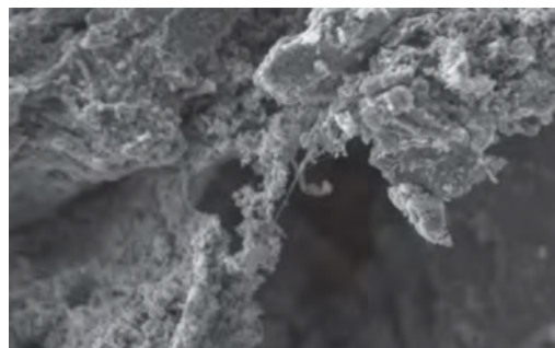
在高放大倍率和低加速电压下对催化剂颗粒成像（左：钨灯丝，右：六硼化镧）。在高难度成像条件下，用户可利用六硼化镧点光源高达 10 倍的束流亮度来增强图像分辨率和衬度。水平观察视野：20 μm。
