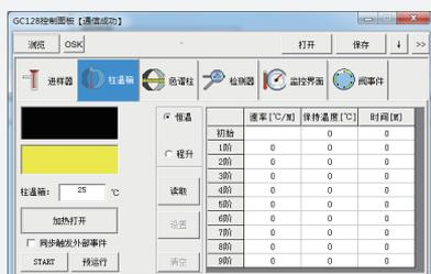
色谱主机反馈控制界面，包括六部分进样器、柱温箱、色谱柱、检测器、监控界面和阀事件，在相应属性页面上查看参数设置与实际值。
