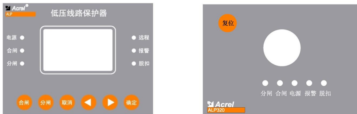
图 23 ALP320 控制器及显示模块面板
