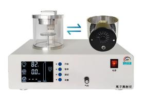
JY-S100 是一款结构紧凑的桌上型镀膜系统,特别适用于扫描电镜成像中非导电样品高质量镀膜。
