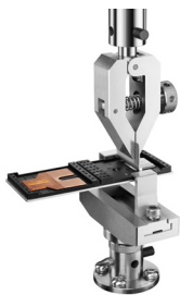
电池盖板极片焊接强度 测试夹具
