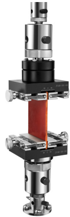
夹层结构侧压强度夹具 ASTM C364
