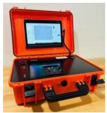
便携式颗粒成像分析仪设计用于对3um至800um的颗粒进行高分辨率精确形状测量，同时适用于便携式现场及实验室台面环境。
