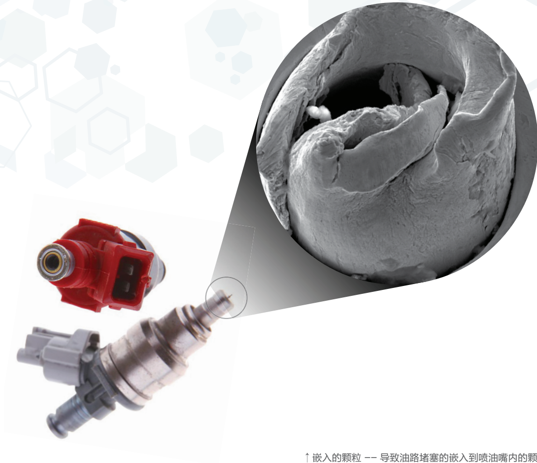
↑ 嵌入的颗粒 -- 导致油路堵塞的嵌入到喷油嘴内的颗粒的 SEM 图像
