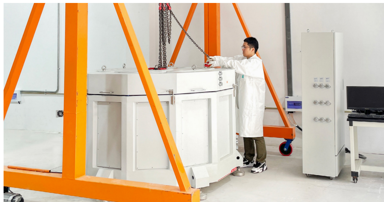
(图为客户定制量热腔直径达 1500mm 的绝热量热仪)
