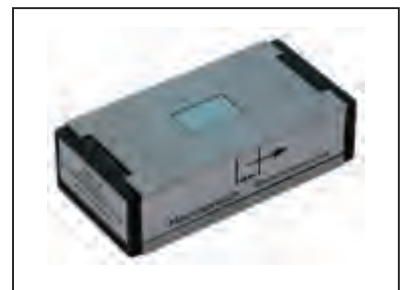
粗糙度标准器: TA-MG-606 Ra=0.5 μm, 带DKD证书 粗糙度标准器: TA-MG-607 Ra=1.5 μm, 带DKD证书 另有Ra=25 nm/50 nm/80 nm可选
