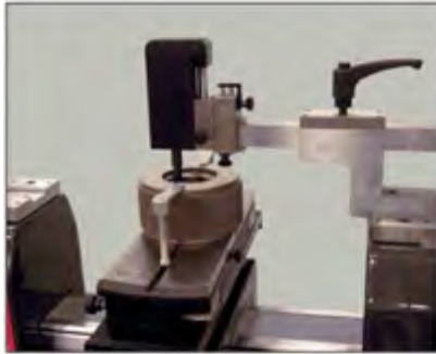
测量螺纹环规 TA-SU-313 / LABC-70 / TA-SU-354
