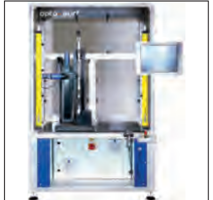
测量齿轮轴圆度、波纹度和粗糙度
