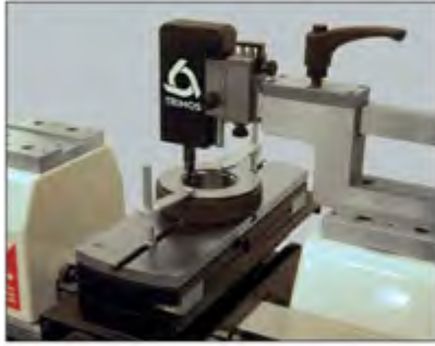
校准螺纹环规 TA-SU-313 / LABC-70 / TA-SU-354
