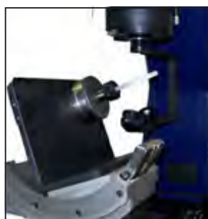
通过双轴转台系统进行自校准, 进一步提高拼接精度
