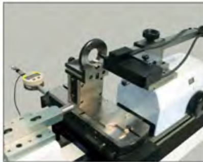
测量锥螺纹环规 HPA-1/ LABC80
