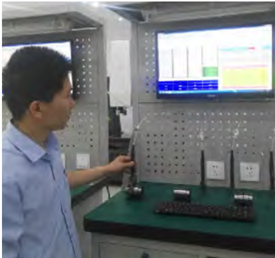
配套气动量仪4座检测站
