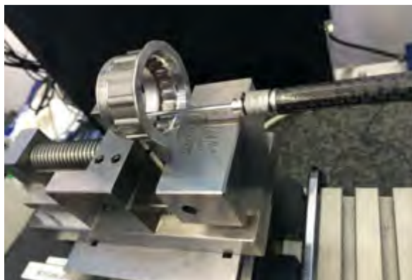
测量自行车零件粗糙度和轮廓
