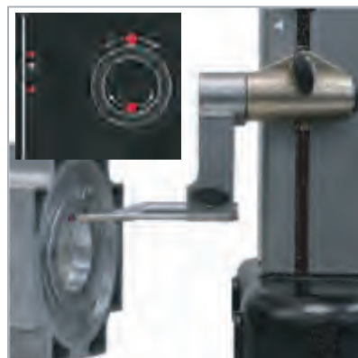
直径测量记录, 拐点自动记录 TA-MI-10
