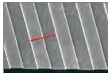
最高精度512纳米光栅
