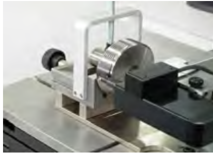
X、Y、Z三轴CNC，全自动测量锥螺纹塞规 TA - MS-381/ TEL75
