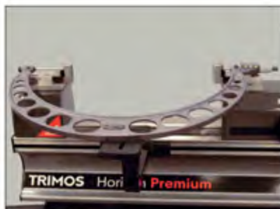
校准大型外径千分尺 TEL5 / TEL11 / LABC20
