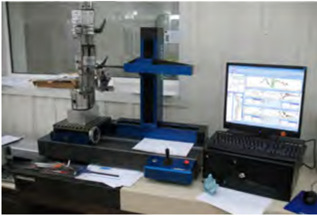
测量变速箱零件圆弧和粗糙度
