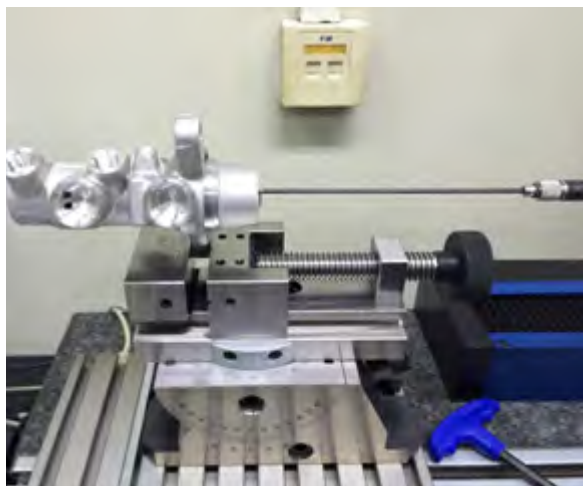
测量刹车主缸粗糙度和轮廓、角度、槽宽、R角
