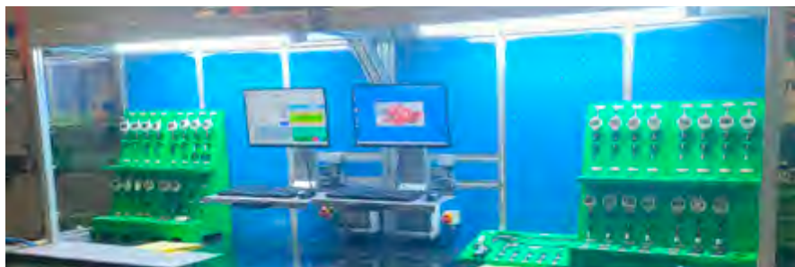
测量界面包含测量值存储、公差智能判断、测量值动态分布图、测量部件信息
