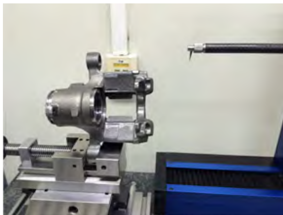
测量制动卡钳零件精度和轮廓
