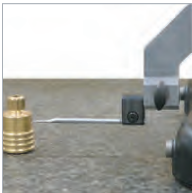
小直径测量 V-50.12 / V-5
