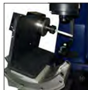
通过双轴转台系统进行自校准, 进一步提高拼接精度
