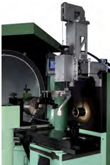
带气动的P5N-Jet装置，用于测量复杂的叶片、叶盘
