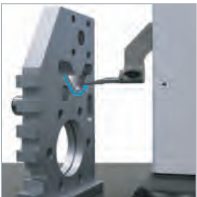
最大值、最小值、差值测量 TA-MI-101 / TA-AD-101
