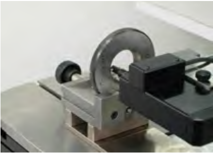
X、Y、Z三轴CNC，全自动测量锥螺纹环规 TA - MS-381/ TEL75
