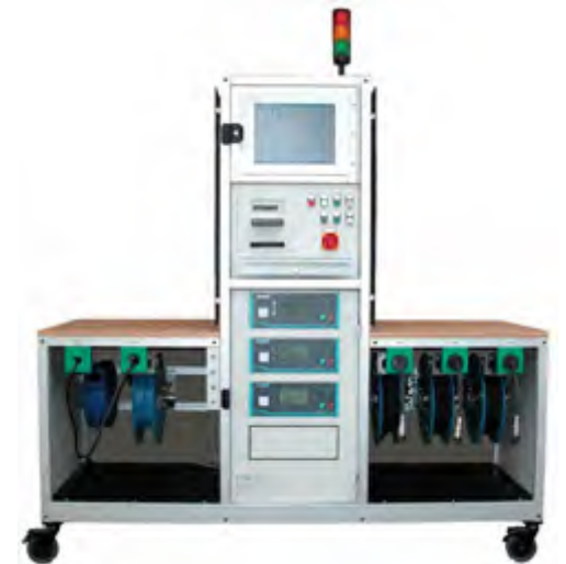
多通道测试系统(例如: 测试商用车的气动回路)
