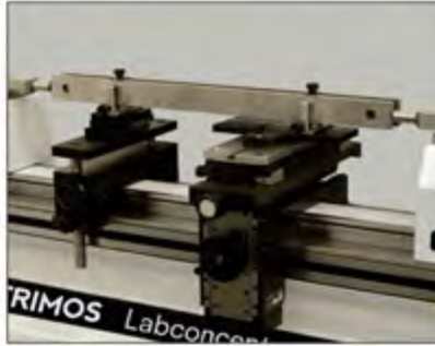
量块比较测量 > 250 mm TELMA7/P/ TA-SU-305/ TA - SU-306/TEL7
