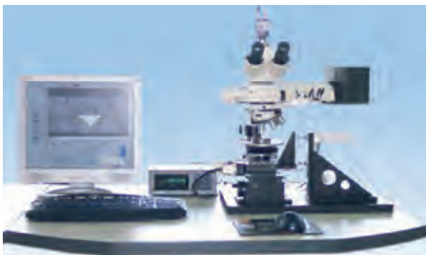
洛氏、维氏压头测量系统，测量金刚石压头几何参数，符合ISO 6508.3和6507.3标准
