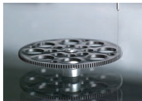
WFP 2D光纤传感器测量小模数齿轮
