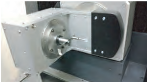
校准转台精度
