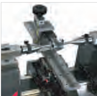
校准螺纹塞规
