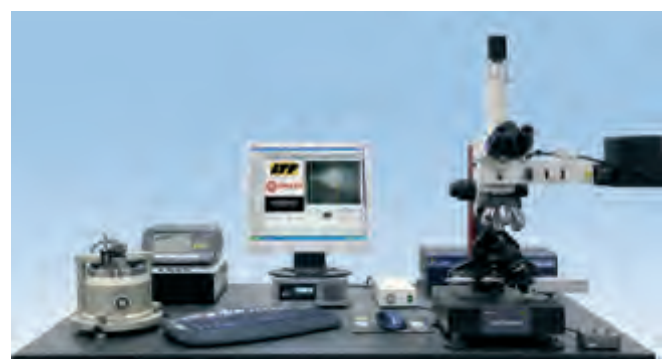
维氏、布氏压痕自动测量系统，误差低于0.5μm；直接测试或复合测试，测量范围从0.02mm到6mm，精度符合ISO 6506.3和6507.3标准
