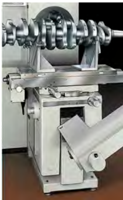
测量重约200kg发动机曲轴实例
