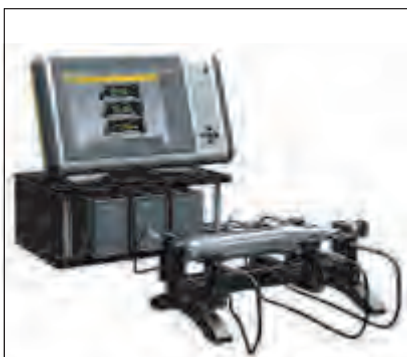
传感器通过D302转换器单元连接D300S
