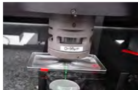
3D光纤传感器不规则透明工件的测量
