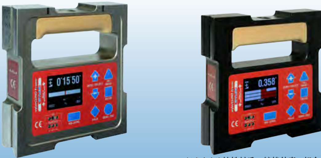
标准底座为铸铁材质、镀镍外壳，铝合金材质可选
