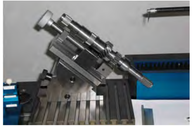
测量变速箱零件粗糙度和轮廓
