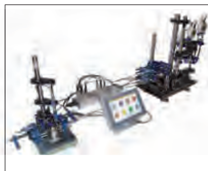
传感器和千分表通过M-BUS总线连接D400S
