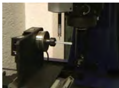
通过探针系统实现厚度测量
