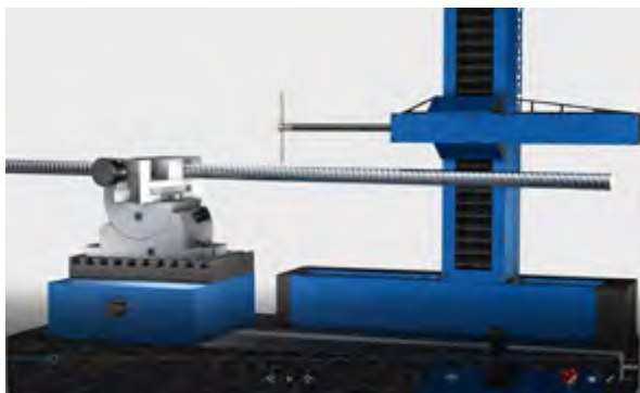
测量丝杠压力角和法向圆弧、偏心距、滚道中径
