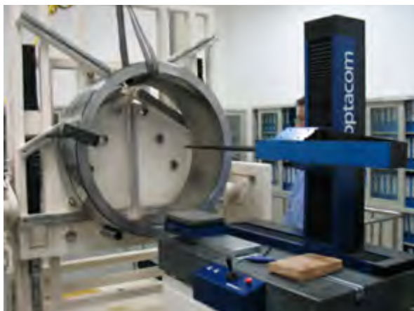
测量轴承滚道圆弧、粗糙度和轮廓
