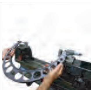
标定检测外径千分尺
