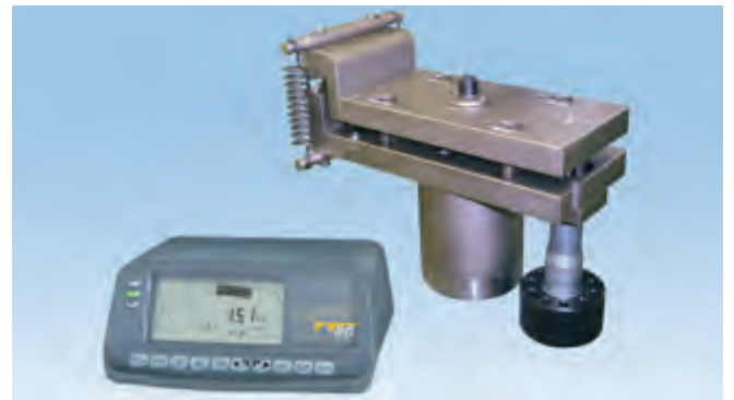
洛氏深度测量装置，精度符合ISO 6508.3标准
