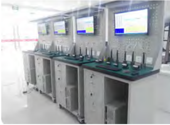
克林贝格、霍梅尔、量检具工作站进行数据读取整合，SPC及现场监控
