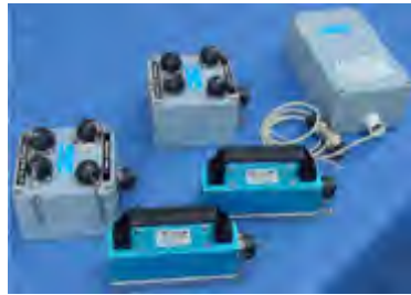
可防水用于恶劣环境的 ZeroTronic测量系统
