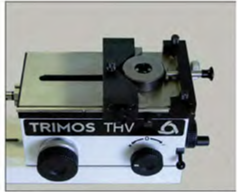
校准光面环规 THV-260
