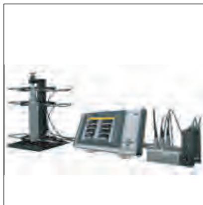
多个仪器连接通过M-BUS总线输入
