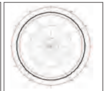
滚子轴承，内圈和外圈：粗糙度和圆度测量
