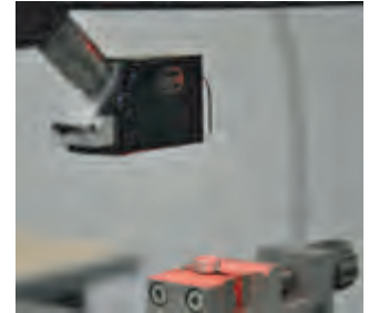
使用光纤探头测量梅花螺钉
