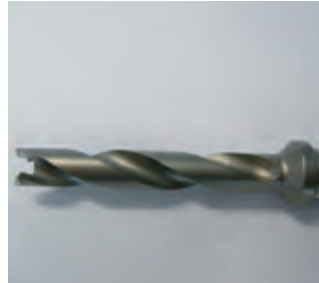
测量可更换式钻头
