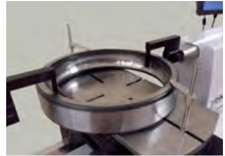
X、Y、Z三轴CNC控制，全自动测量轴承套圈
