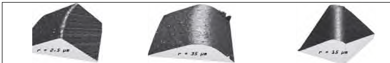
刀具形状和粗糙度同时测量
