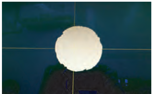
光学CCD对喷油孔定位
