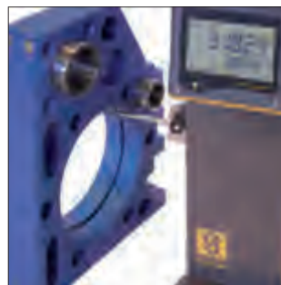
内孔测量，采用 \varnothing 3\text{mm} 红宝石标配测头
