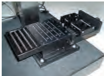
双模板大工作台，测量时可同时定温待测量块
