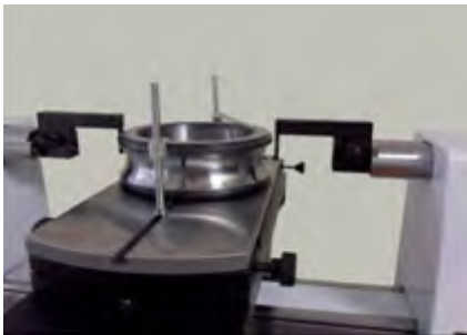
X、Y、Z三轴CNC控制全自动测量轴承套圈内圈
