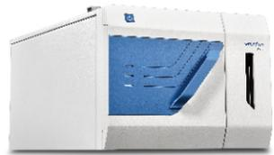
超高效自动进样器,采用超高压针在流路无损进样技术,具有极低的进样循环周期。由于进样针在高压流路中始终冲洗,具有极低的交叉污染。制冷的样品室,能够保存生物样品等易变质的被测物质。
