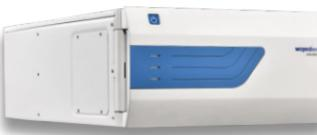
超高效二极管阵列检测器,采用专利的液芯波导流通池技术,实现光能量的无损传输,配合独有的最小化杂散光技术,带来极高的灵敏度和信噪比。具有超高的检测速率,能够充分发挥超高效液相的性能。
