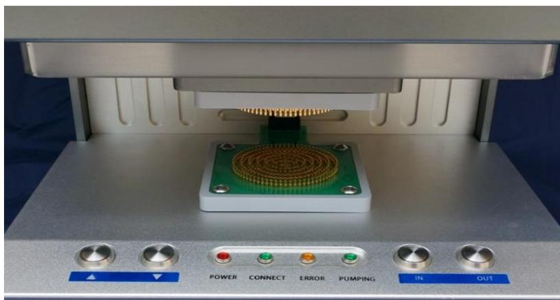
仪器上部测试头和下部测试头由多环镀金探针组成，盐水从上部测试中心滴入布料，液体在布料中扩散，模拟人体出汗过程，上下探针快速测试相邻两环的电阻变化，每个相邻环电阻值动态传输到电脑分析软件，电脑分析，计算出动态扩散数据，整个测试过程需要2分钟时间。
