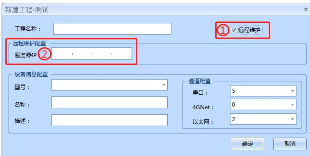
工程新建过程中也可跳过以上步骤，远程服务器 IP 也可后期直接在工程配置信息界面增加及修改，如下图所示：（注：服务端不用填，默认 16008）
