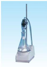
此装置用于化学需氧量COD测定的最后程序,用高锰酸钾标准溶液滴定。
