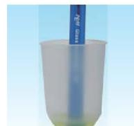
样本量10mL专用的测量容器。最多的滴定体积为50mL。适用于无法稀释的样品。
