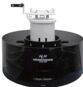
CHA-700有6个或11个样品位,自动执行滴定。空的样品位可随意放置,依据放置样品的先后顺序,依序完成滴定程序。主机可安装在CHA-700上,节省工作空间。
