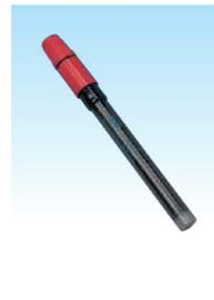
表面活性剂的分析,一般为两相滴定法,使用有毒的三氯甲烷为溶剂。用此电极可不使用三氯甲烷,并可快速测量阳离子和阴离子表面活性剂的浓度。
