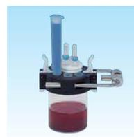
密封式滴定池,用于高挥发的样品,或无法在空气环境下的滴定试验,另可外接旁支管通入氮气。
