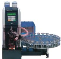
适用于卡尔费休库仑法水分仪的多样品蒸发器，可同时放置24个样品连续测量。每个样品加热温度可单独设定，不同类型样品可连续测量。测量后自动断电确保安全。
