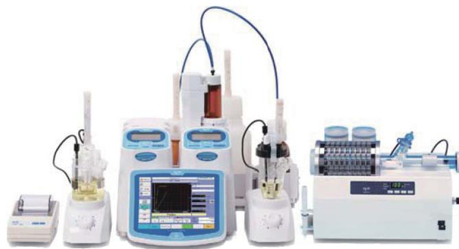
此蒸发器与卡尔费休测定仪主机连接，可测量固体或粉末的样品，或会产生副反应或无法直接滴定的样品。样品放置在样品舟上，经由密封管中磁力驱动至加热炉，蒸发的水分由载气带入至滴定池中。避免大气湿度的影响，进行可靠和准确的微量水分测量。专利温度扫描模式，可自动确定最佳的加热蒸发温度。加热管构造简单且容易清洗。
