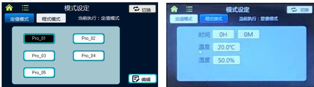
系统有定值模式和程序模式 2 种控制模式。在程序模式下，可修改程序名称，每个程序可设置运行周期（0~999）、段数（1~100）、时间（0~999:59）、温度、湿度等控制量。
