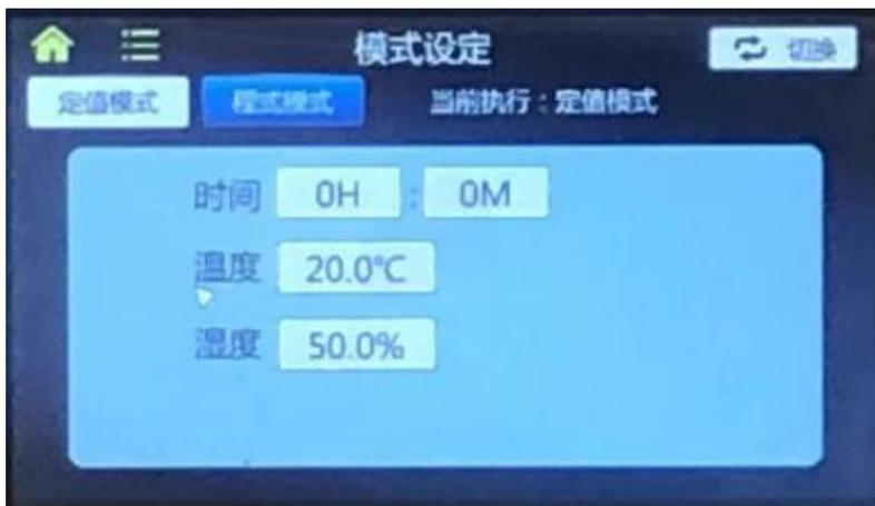
例如：设定温度 20.0℃、设定湿度 50.0%RH、一直保持运行，设定操作流程如下：首先在【目录】界面中选择【模式编辑】，再点击定值模式按键，进入【定值模式】设定编辑界面，设置如下表所示：
