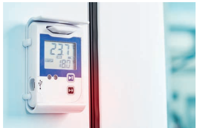
数据记录仪可通过磁力固定在 Versafreeze 超低温冰箱上，通过 USB 接口进行配置或读取
