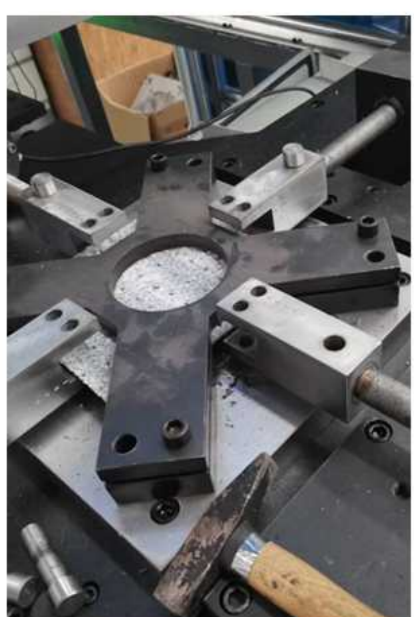
试样表面处理
