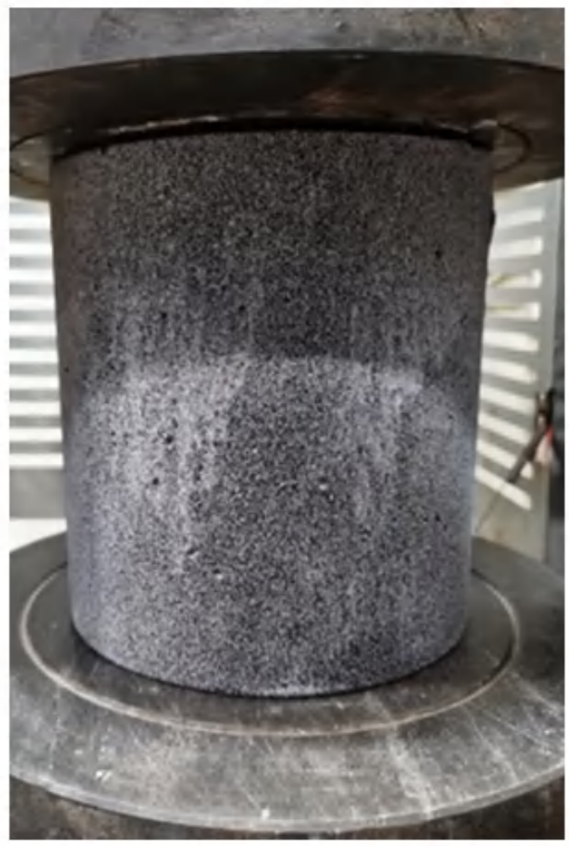
试样表面处理
