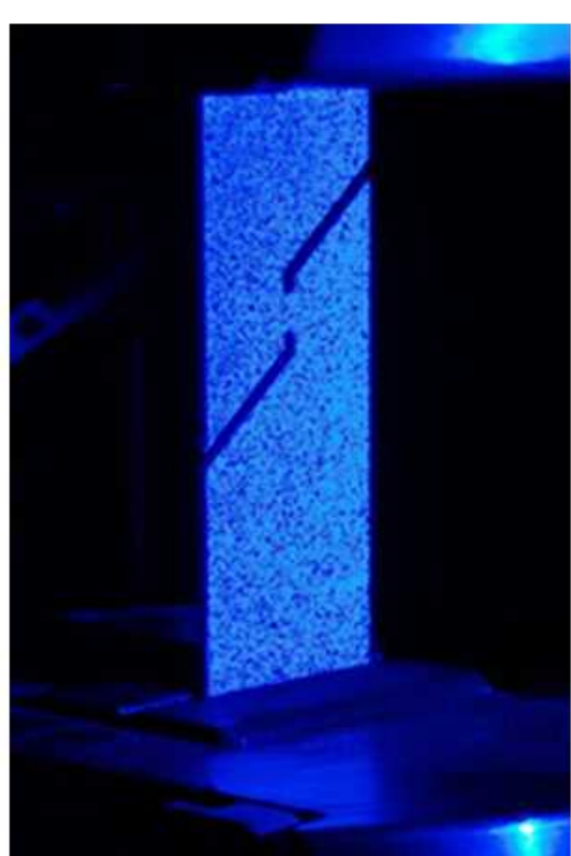
试样表面处理
