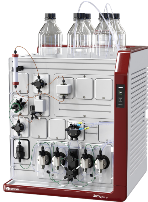
图 1. ÄKTA™ pure 是一个灵活的分层析系统，可在实验室规模上可靠地纯化蛋白质、多肽和核酸
