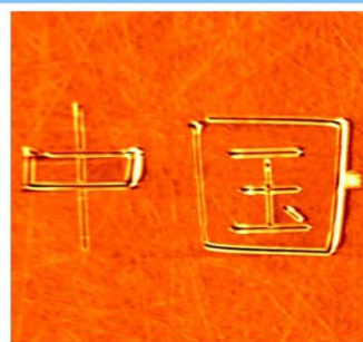
操纵微探针，在基底上刻画出“中国”的字样
