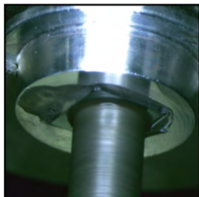
将样品粘牢在样品台（铝台）上，然后用EM TXP空心钻冲钻获得直径3mm圆柱体。
