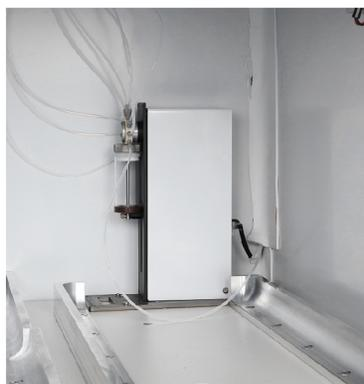
接种、抑制剂，进样，转移，营养液自动配制等使用的精密注射器
