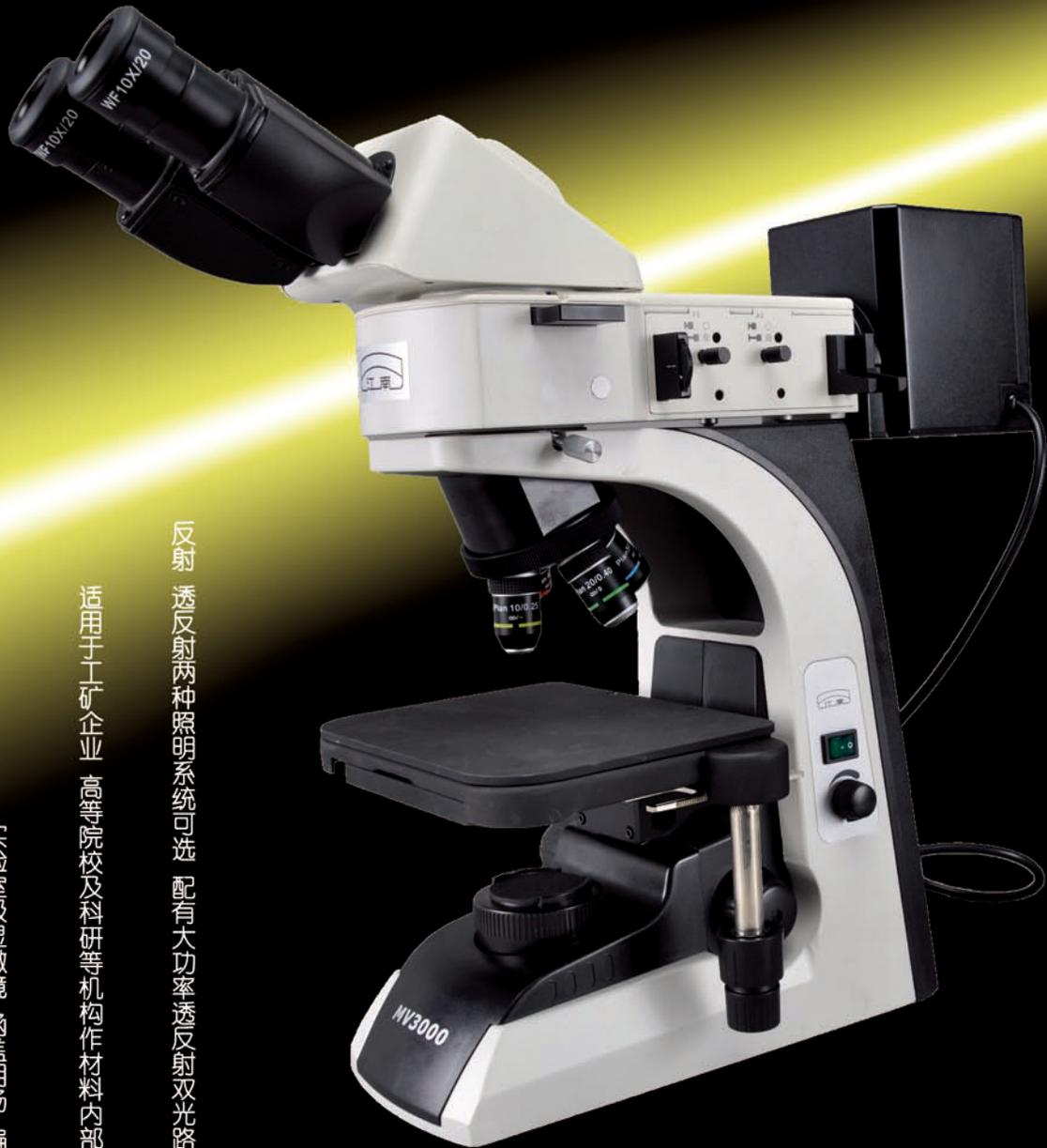
反射 透反射两种照明系统可选 配有大功率透反射双光路柯勒照明系统
