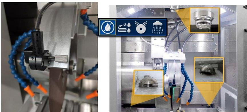
AbrasiMet L Pro 标配三轴操纵杆，X 轴方向，刀片可移动，市场上切割机通常是平台移动且为选配。中间带有分隔槽的可移动 T 型槽切割平台，以获得较大的切割能力且防止设备损坏。
