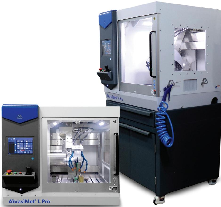
AbrasiMet L Pro 具有 4 种切割模式：垂直切割、Y 轴切割、平切和手动切割，可实现序列切割、切割启动检测、脉冲切割、可变智能切割功能。方法可存储，保证切割的一致性。用户可设置主轴电机的最大输出功率，介于 30% 和 99% 之间。SmartCut 是一种保护功能，一定程度上保护样品和刀片。该功能将降低进给速度，以满足最大电机限值的要求。未知情况可设大的电机功率，不会损坏机器，同时可以通过样品表面质量判断进给速度是否合适。设置高进给速度坚→机器将在整个切割过程中控制进给速度→保证切割质量的同时，以最快速度完成样品的切割。
