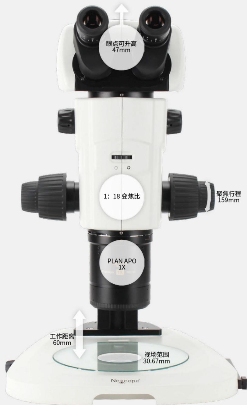
NSZ818 的光学系统均采用了多层镀膜的高性能光学透镜，0.75X-13.5X 的变倍物镜配合全新设计的 1X PLAN APO 大物镜，变焦倍率比达到 1:18，在 10X 目镜下能够实现 7.5X-135X 的变倍范围，让您既可以在低放大倍率下进行高质量的整体观察，又可以快速放大以进行微米级的细节观察。
