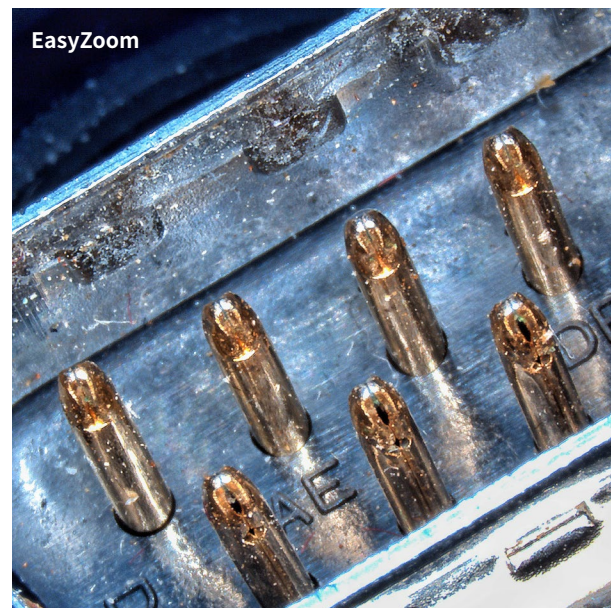
结合 360° 支架可获得一张倾斜并全幅对焦的样品图，方便用户对样品侧面进行更仔细的观察。
