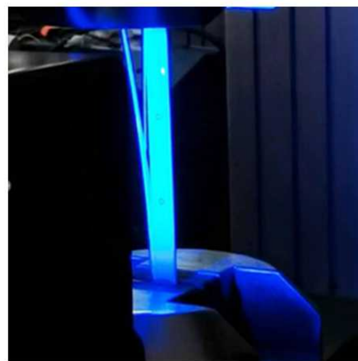
玻璃纤维断裂过程
