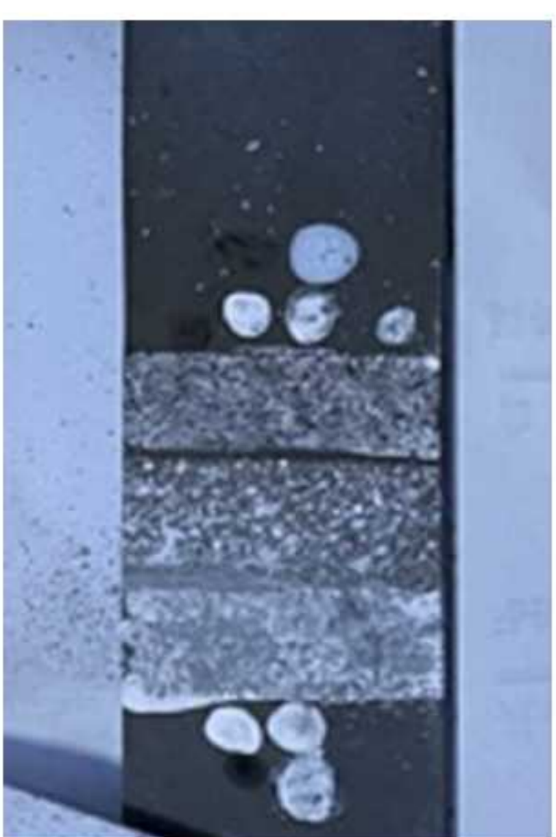
试样表面 布置高温散斑
