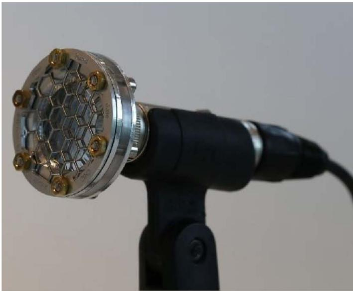
电容式麦克风 Avisoft Bioacoustics CM24/CMPA 提供大的灵敏度（低噪声）和平坦的频率响应。由于其 24 毫米的更大光圈尺寸，它比标准型号 CM16/CMPA 更具方向性。它由（可更换的）外极化金属化薄膜隔膜和金属背板组成。此麦克风型号需要由 UltraSoundGate 基本单元提供的额外 200V 极化电压。可用于 CM16/CMPA
