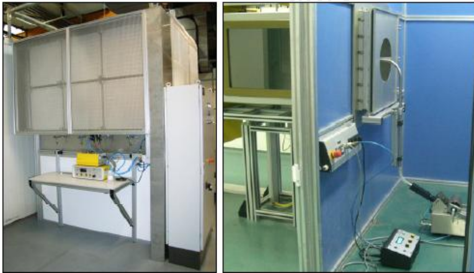
图3 带进气口过滤器的混合室和气溶胶发生器（粉尘和雾化）；右图为混合室内部视图
