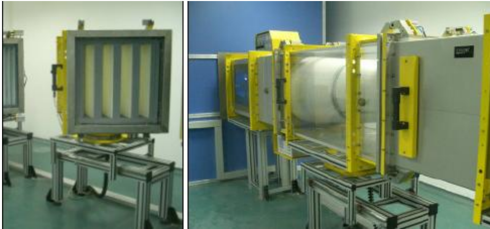
图 4 测试管道中的待测过滤器样品
