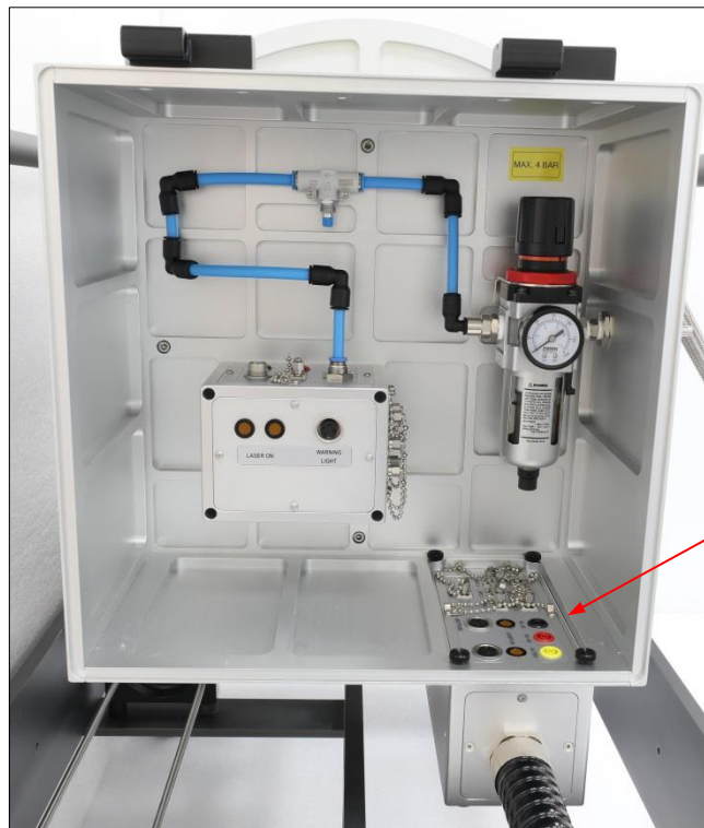
断线盒安装在卷筒外壳上，并使用与断线盒一起提供的四个拇指螺丝固定在适当的位置
