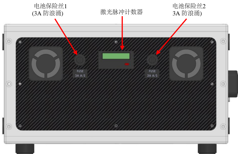
LIBSProbe仪器控制台的后面板显示激光脉冲计数器和锂离子电池熔断器1和2
