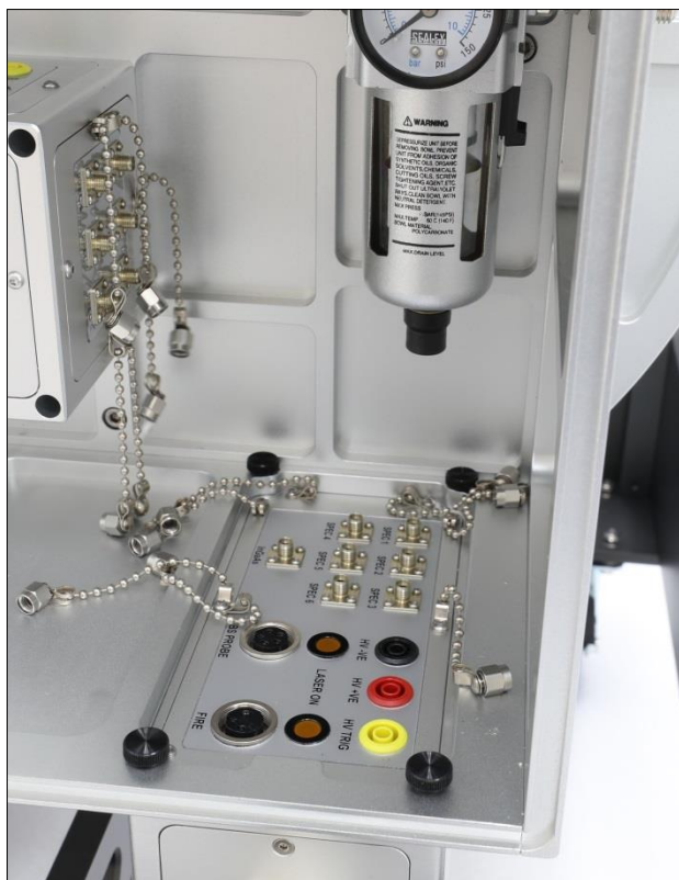
从光纤 SMA 连接器上拆卸防尘盖。
