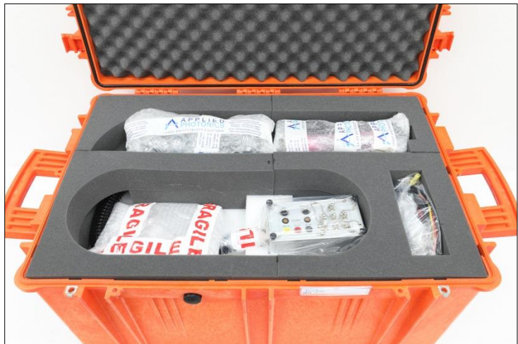
转运箱外壳，用于装置仪表控制台及相关部件和附件。
