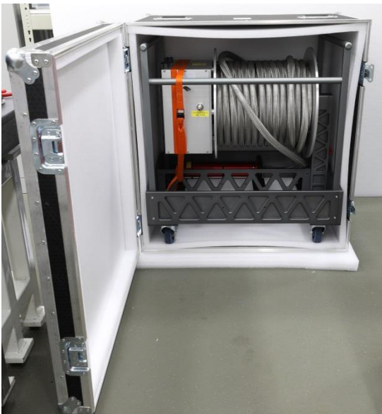
转运箱外壳，用于装置仪表控制台及相关部件和附件。
