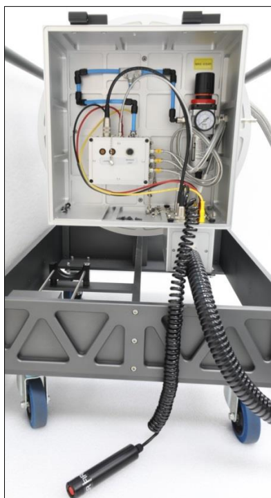
“激光点火”按钮连接到断路器上的“点火”连接器
