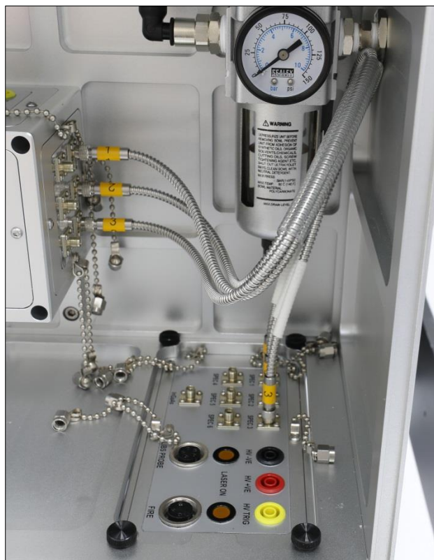
如图所示，安装1、2及3号光纤电缆至规格1、规格2及规格3连接器
