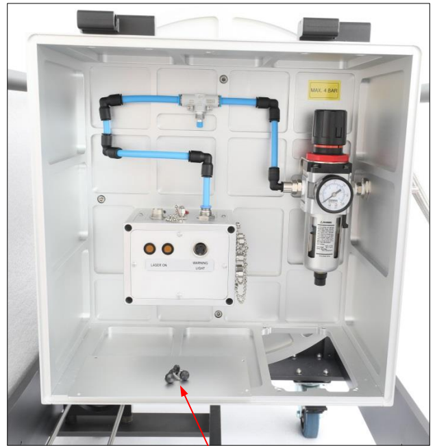
如图所示，在外壳内临时存储面板和四个拇指螺丝钉
