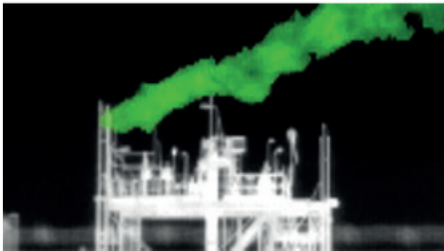
实时使用Hyper Cam从350米的距离检测到氟利昂,并进行量化,计算出的泄漏率确定为10000 g/h
