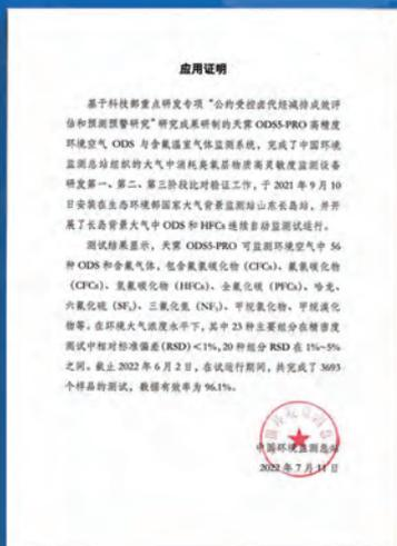
国家大气背景监测站山东长岛站天霁ODS5-PRO系统于2021年9月10日安装，连续监测环境空气中CFCs、HCFCs、HFCs、甲烷氯化物、甲烷溴化物等受控卤代烃。在环境大气浓度水平下，其中23种主要组分在精密度测试中相对标准偏差（RSD）<1%，20种组分RSD在1%~5%之间。该系统于2021年12月起按照中国环境监测总站技术规范开始业务化运行，是国内最早开始业务化运行的环境空气受控卤代烃自动化连续在线监测系统。2022年监测数据和相关结果已总结为决策报告通过中国环境监测总站上报并获得生态环境部领导批示，为我国履行国际承诺作出了重要贡献。
