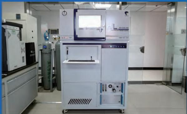
中国环境监测总站天霁ODS5-PRO系统于2021年10月29日安装，配置多通道罐进样模块和辅助进样模块，用于多个背景站定期离线采样样品的分析。该系统为国家重点研发计划《重点受控卤代烃的关键监测技术研究和应用》提供了有力的数据支持。
