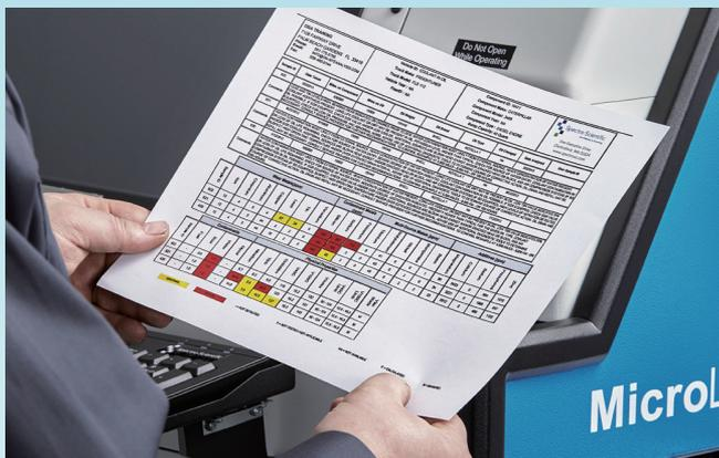
MicroLab自动生成内容详实的彩色检测报告，自动对异常结果以醒目颜色进行标识。监测报告包含对各项监测指标的趋势分析及分析诊断建议。
