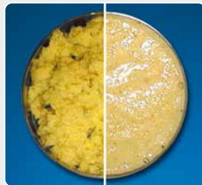
上图显示了使用家用混合搅拌器(左)与使用GM200(右)对生土豆进行粉碎所得的粉粒度比较
