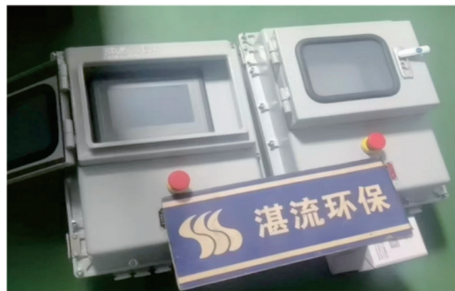
防爆PLC控制箱
