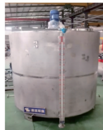
尿素溶液搅拌罐
